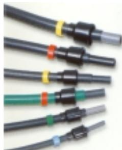
Il **TRW** è un tubo calibrato **antiscintilla** tipo "TRX" in poliammide 12 rinforzato esternamente di un ulteriore strato per migliorare la protezione contro le scintille e le scorie di saldatura. La guaina esterna può essere facilmente asportata per l'utilizzo con raccordi ad innesto e disinnesto rapido. Accoppiando questo sistema con il cappuccio di protezione, si ottiene la massima garanzia di resistenza e funzionalità.
