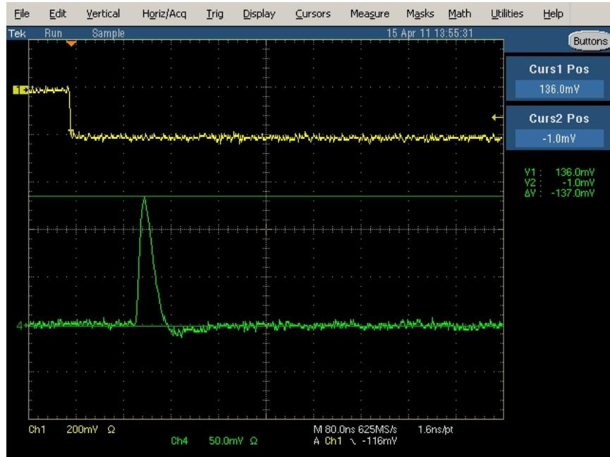
$Q_{in}=200 \text{ fC}$ , Cable attenuation (18 m)=0.57, rise time=16 ns,  $V_d=137 \text{ mV}$ .
