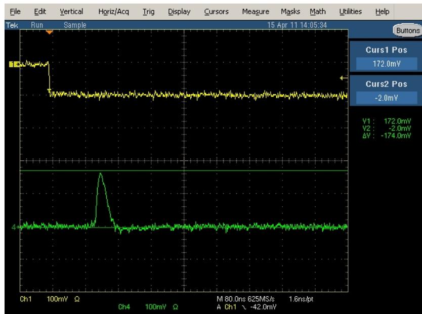
$Q_{in}=100 \text{ fC}$ , Cable attenuation (18 m)=0.57, rise time=16 ns,  $V_d=174 \text{ mV}$ .
