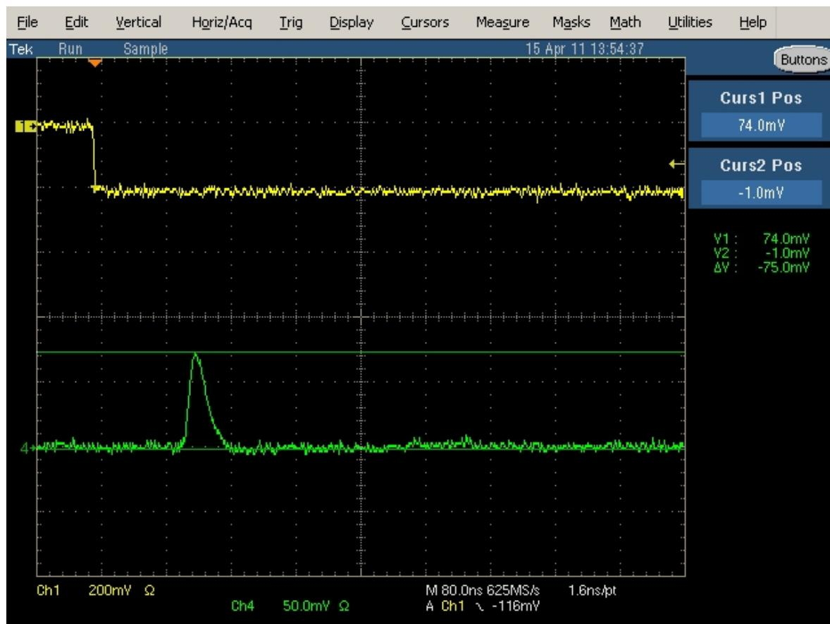
$Q_{in}=200 \text{ fC}$ , Cable attenuation (18 m)=0.57, rise time=16 ns,  $V_d=75 \text{ mV}$ .
